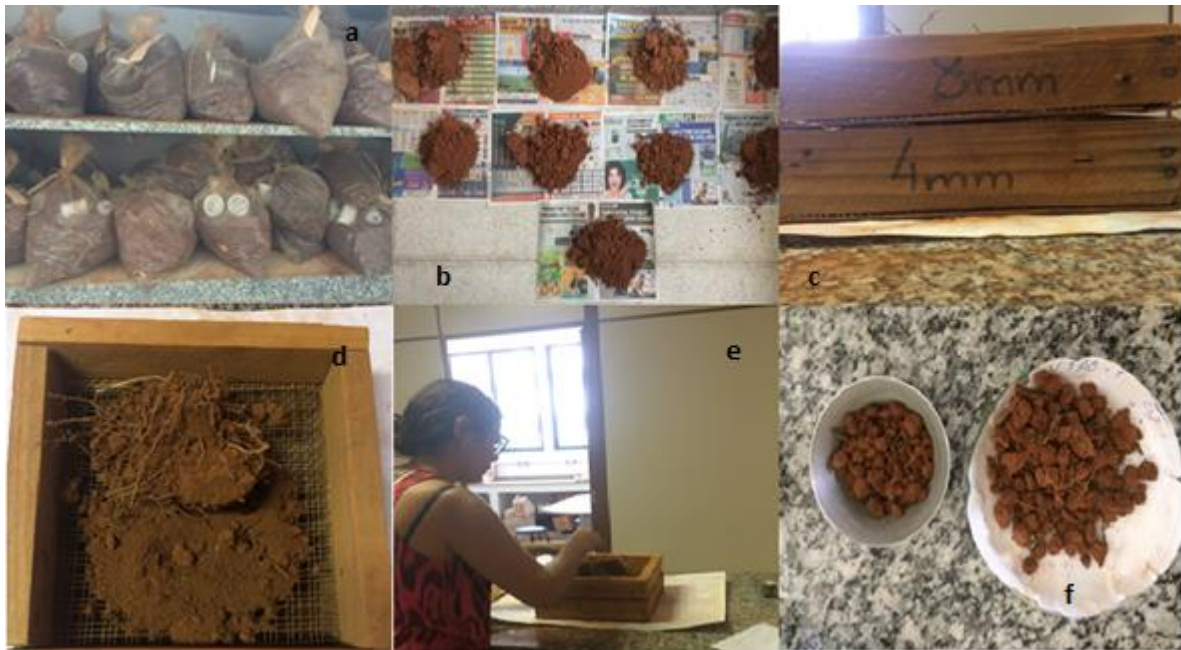
Figura 7 – a) amostras de solo armazenadas e identificadas; b) solo seco ao ar; c) peneiras de malha 8mm e 4mm; d) solo seco ao ar no conjunto de peneiras (8mm em cima e 4mm em baixo); e) Leila D. Abreu (mãe) ajudando no laboratório; f) fôrma com 10g e placa de Petri com 25g, ambos já pesados. Fotos: Polyanna Abreu Corrêa.
