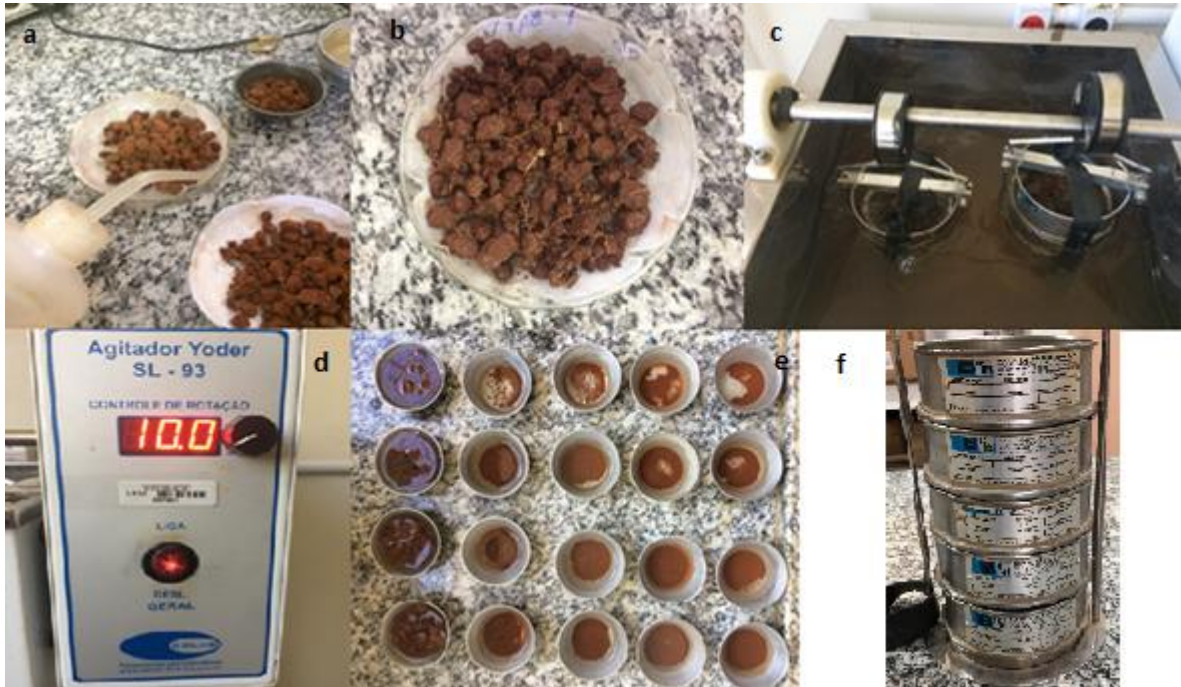
Figura 8 – a) amostras de solo sendo saturadas com pisseta e água destilada; b) amostra saturada após 15 minutos; c) conjunto de peneiras no Agitador de Yoder; d) agitador de Yoder configurado para 10 r.p.m.; e) solo retirado das peneiras, em cinco tamanhos/classes diferentes; f) conjunto de peneiras. Fotos: Polyanna Abreu Corrêa.
